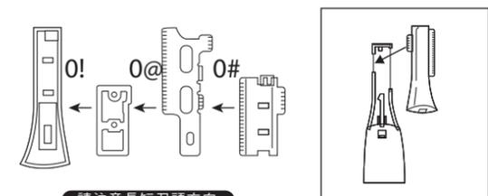
2. 對準上方卡準，蓋上刀片蓋，上推刀片拆卸鍵鎖定，即可正常使用。
