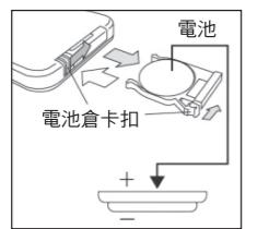
遙控器電池規格CR2025，更換方式如下說明。
