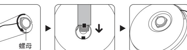
1. 首先拿出立柱管，將安裝在立柱管底部的螺母轉開並拆下。
