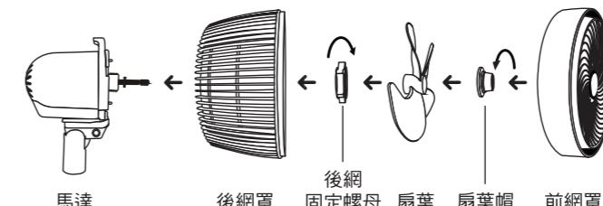
3. 將風扇組件裝入馬達上，順序為：後網→後網固定螺母(順時針方向轉入)→扇葉→扇葉帽(逆時針轉入)→前網罩。
