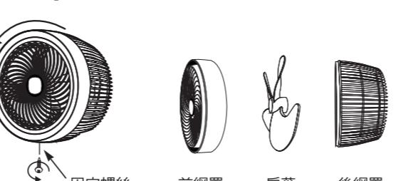
1. 將前網罩下方的固定螺絲拆下，將前網罩依箭頭方向轉動，再向前拉即可取下前網罩。(拆下的螺絲請妥善保管，組裝時需重新安裝上)
